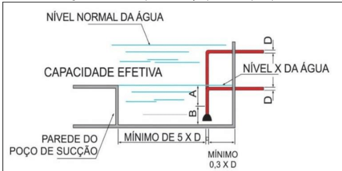
Figura B.2: Tomada superior de sucção para bomba principal
