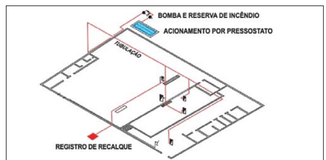
Figura 65: Perspectiva isométrica de sistema de hidrantes
