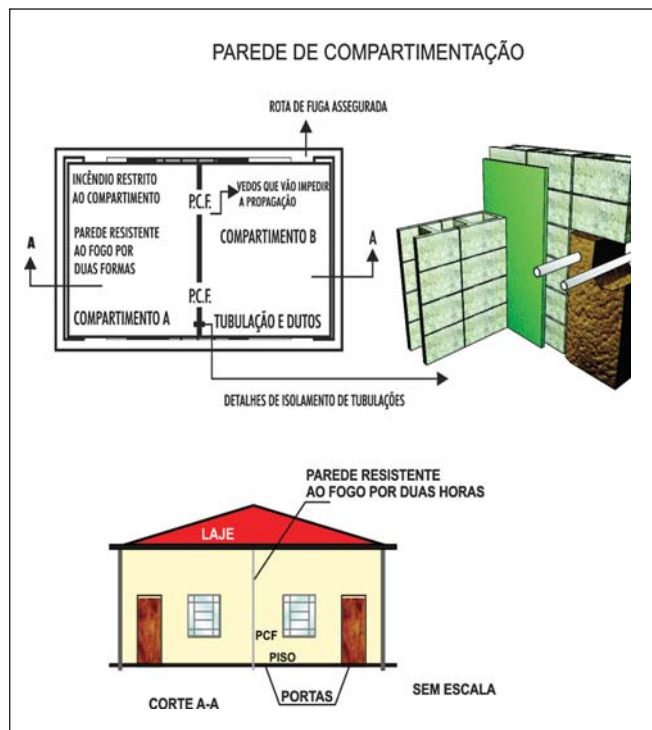
Figura 32: Detalhes de parede de compartimentação
