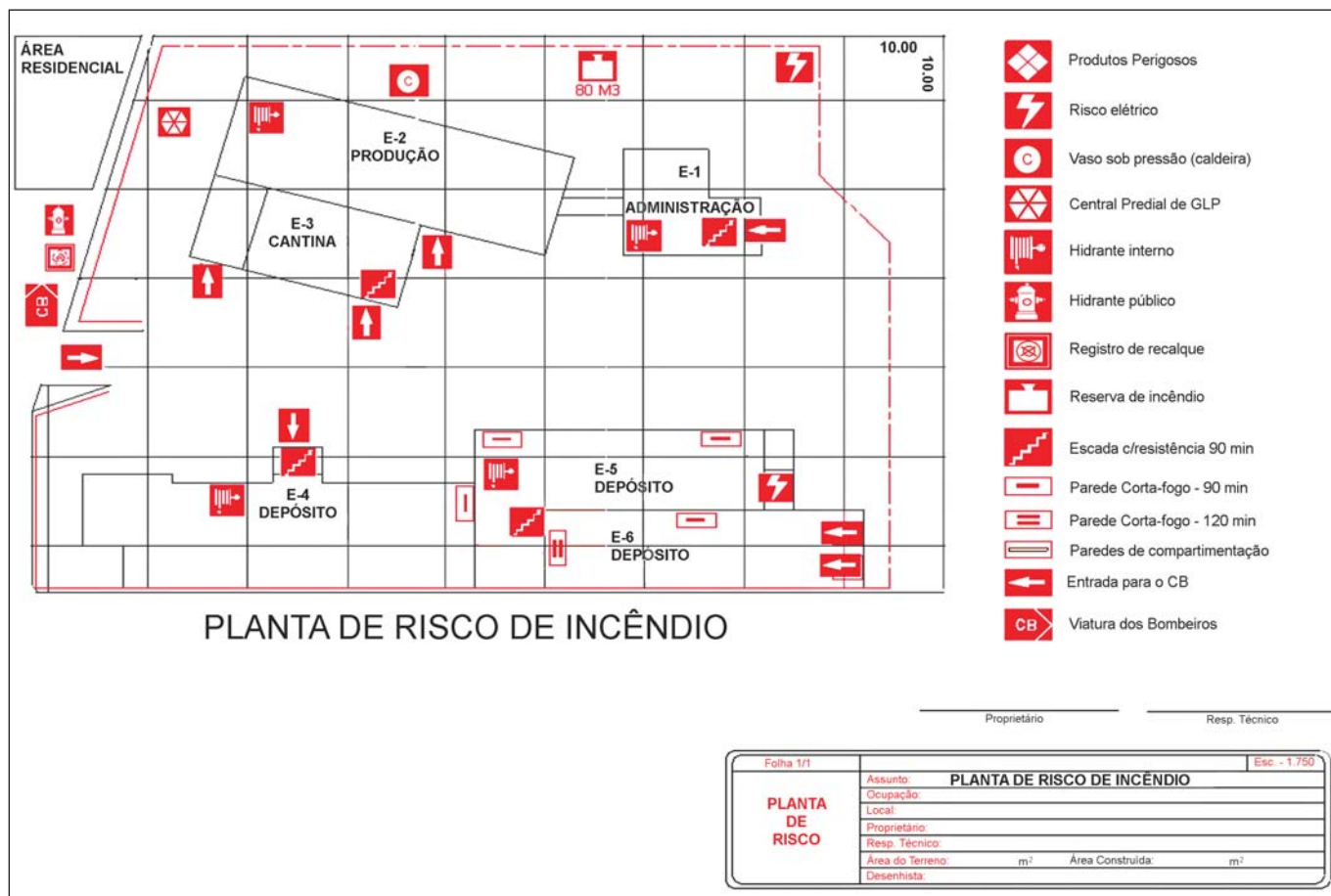
Figura 75: Planta de risco. Fonte: IT 01/11.
