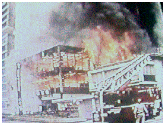
Figura 23 - Propagação por convecção, onde gases quentes fazem com que ocorra focos de incêndio em andares distintos
