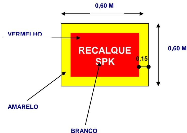
OBSERVAÇÃO: QUANDO TAMBÉM HOUVER SISTEMA DE HIDRANTES, O SEU REGISTRO DE RECALQUE DEVERÁ SER SINALIZADO DA MESMA FORMA ACIMA, PORÉM SUBSTITUINDO-SE AS LETRAS "SPK" POR "HID".
