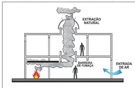
Figura 25: Extração de fumaça de áticos
