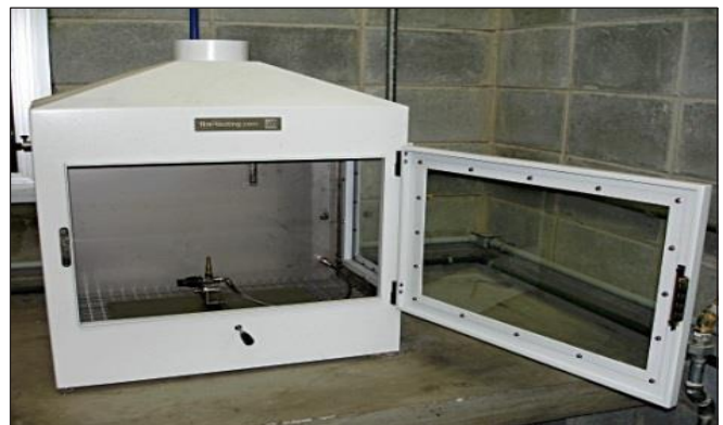
Figura 34: Determinação da ignitabilidade dos materiais
