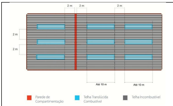
Figura 2: Afastamento de telhas translúcidas combustíveis
