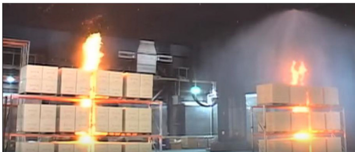
Figura 2 – Início da ação do chuveiro automático em uma amostra
