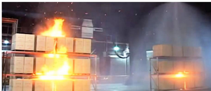
Figura 3 – Controle do incêndio em uma das amostras
