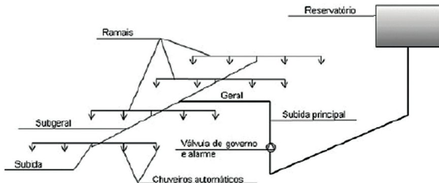
Figura 11 - Esquema dos componentes do sistema de chuveiros automáticos
