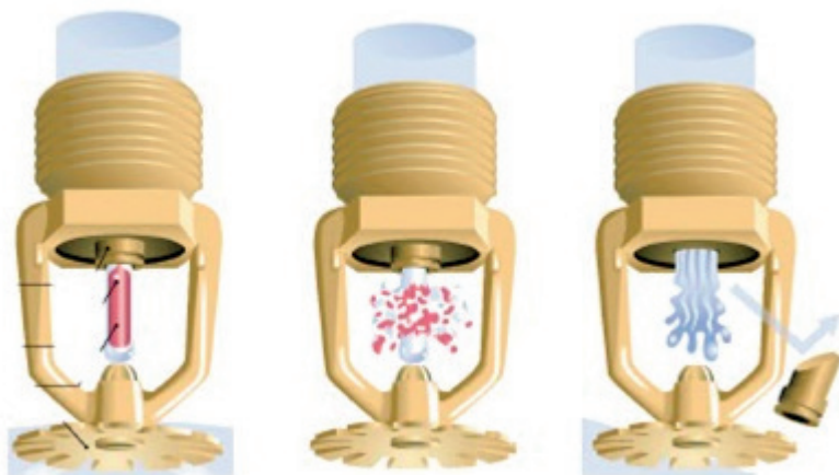
Figura 5 – Funcionamento do sprinkler
