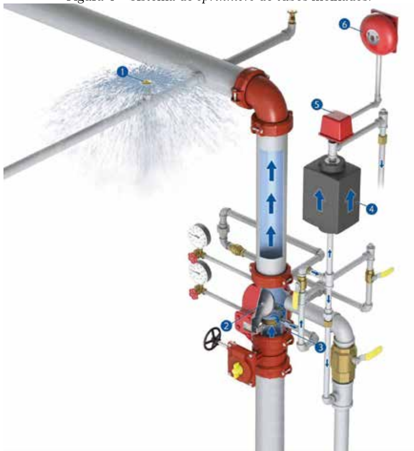
Figura 4 – Sistema de sprinklers de tubos molhados.
