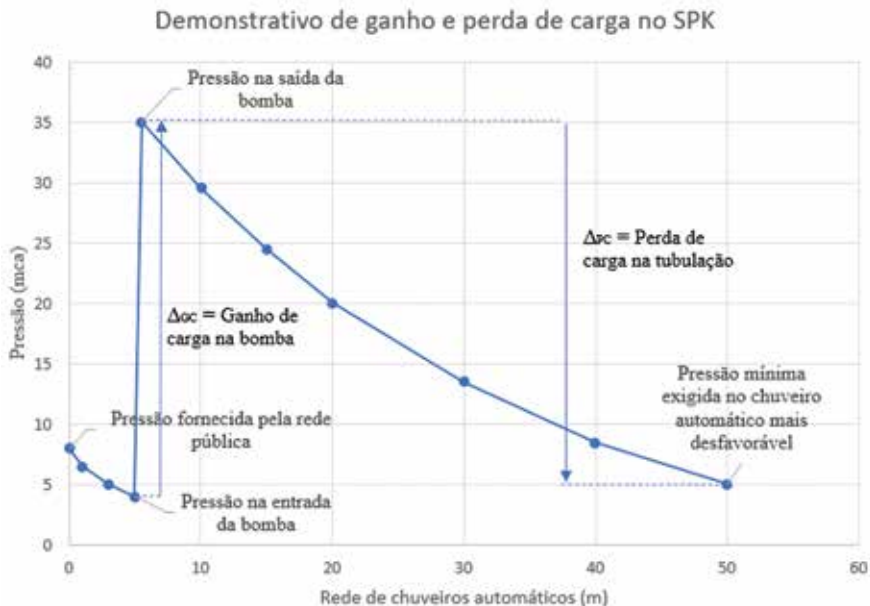
Figura 2 – Gráfico demonstrando o ganho e perda de carga no sistema de SPK
