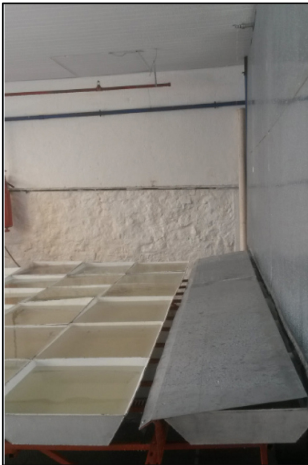
Figura 18 – Estação modernizada de ensaio de distribuição em sprinklers laterais
