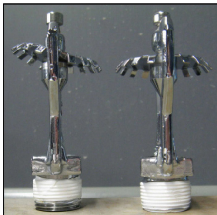
Figura 29 – Exemplo de defletor que sofreu deformação após teste de resistência ao fluxo de água por ser forjado em liga metálica imprópria (sprinkler à esquerda)
