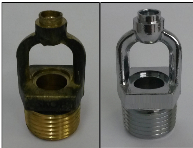
Figura 26 – Corpo forjado em latão recém-usinado (esq.) e com acabamento cromado (dir.)
