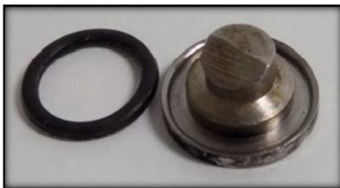
Figura 35 – Anel elastomérico proibido
