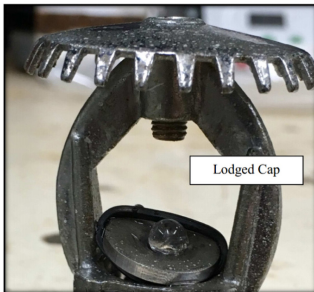
Figura 41 – Alojamento do obturador em função da utilização de anel de borracha (o-ring)
