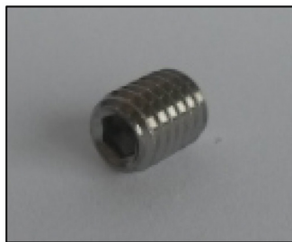
Figura 36 – Parafuso de fixação do mecanismo de desarme e vedação do sprinkler
