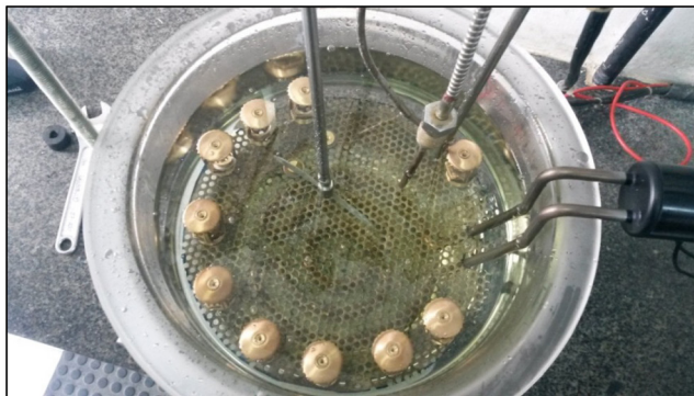
Figura 19 – Estação modernizada de ensaio de temperatura, exposição ao calor e choque térmico
