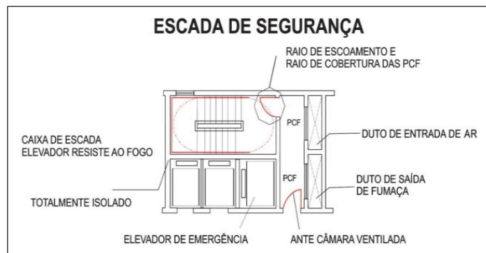
Figura 41: Escada e elevador à prova de fumaça.
