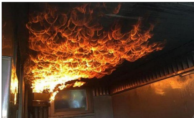
Figura 19: Fase anterior ao “ flash over ” – grande desenvolvimento de fumaça e gases, acumulando-se no nível do teto (Fonte: rede mundial de computadores).
