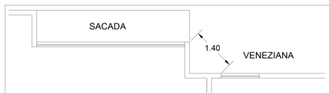
Figura 9: Distância entre a veneziana da escada EP e qualquer outro tipo de abertura no mesmo plano
