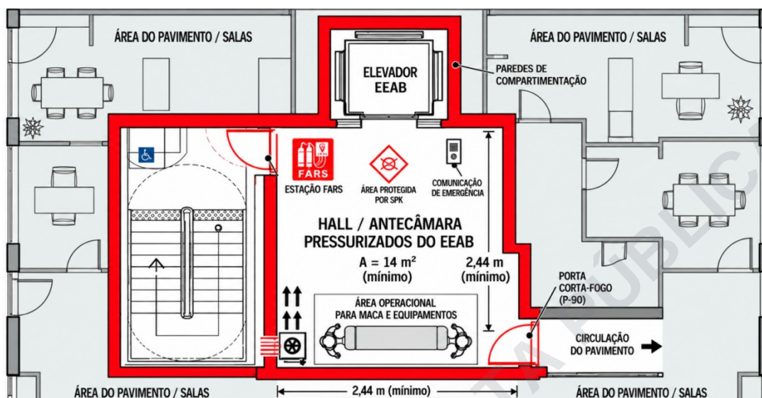
Figura B.1 — EEAB: Hall/antecâmara pressurizado do EEAB com comunicação direta com a escada pressurizada (esquema ilustrativo).
